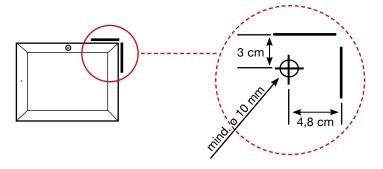
Bohren Sie ein Loch für das Kabel (etwa 10 mm Durchmesser) durch das Kabinendach oder durch die Kabinenwand.
